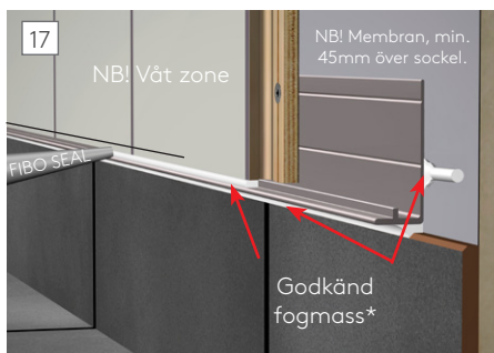
17 För att monteringen ska vara godkänd och garanti ska gälla måste alltid godkänd fogmassa användas. Se bild för hur fogmassa ska påföras.
